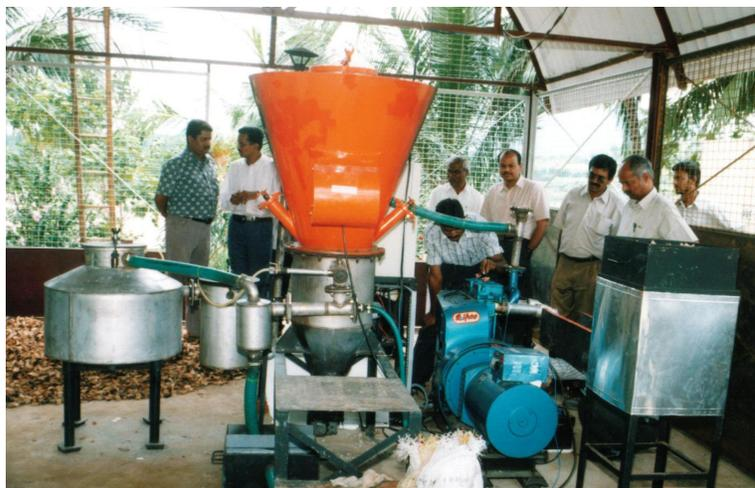
Gaseificadores como o apresentado acima são fornecidos completos e possuem muitos de seus componentes padronizados para facilidade de montagem, operação e manutenção. Neste exemplo em particular temos um sistema completo para geração de energia elétrica operando no modo 100% gás (sem adição de diesel) com potência elétrica líquida de 7kWe. Da mesma forma poderíamos
